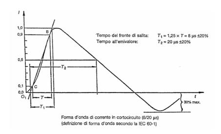
Per la porta di alimentazione l'impulso va applicato (accoppiato), tramite la CDN, tra i conduttori di linea a due a due (accoppiamento di modo differenziale), e tra ciascun conduttore di linea e la terra di riferimento (accoppiamento di modo comune).
