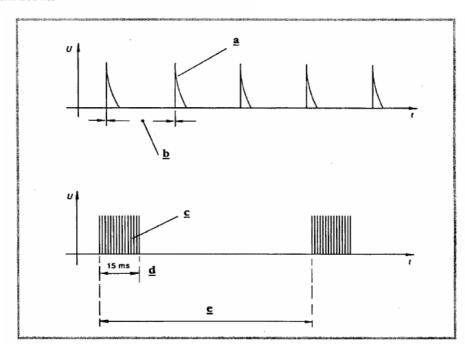
La norma prescrive di applicare il segnale di prova alla porta di alimentazione dell'EUT, e alle porte di Input/Output e di comunicazione dell'EUT con altri apparati e/o altri componenti staccati facenti parte dell'EUT stesso.
