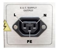
Se la cdn e' alimentata con tensione continua non serve il trasformatore d'isolamento, se invece viene alimentata con tensione alternata non isolata allora e' indispensabile collegarla al trasformatore d'isolamento.
